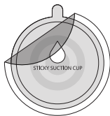
2. Staccare la pellicola protettiva sulla ventosa e premere saldamente il supporto sul cruscotto.
